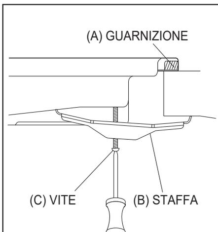
1. Posizionare le staffe sopra il foro che corrisponde alla dimensione delle viti. Ci sono una serie di fori per le viti in ogni angolo del piano di cottura (H).
