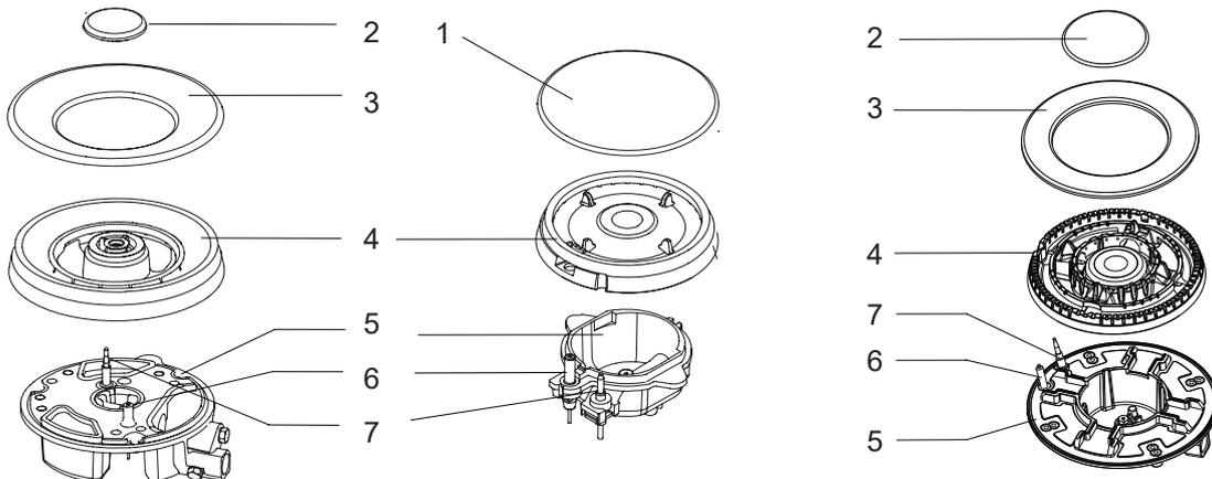
1. Posizionare lo spartifiamma (4) sulla coppa del bruciatore (5) in modo che il dispositivo di accensione e il dispositivo di controllo fiamma si innestino dentro i rispettivi fori nello spartifiamma. Lo spartifiamma deve posizionarsi correttamente in posizione.
