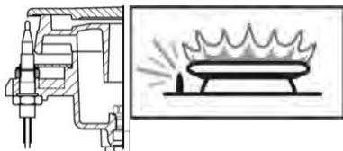
L'apparato termico attiva il meccanismo di sicurezza intercettando il gas nel caso di spegnimento dei bruciatori in seguito al trabocco di liquidi
