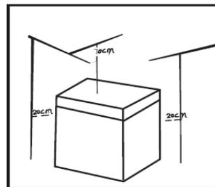
Sulla parte superiore del congelatore deve esserci uno spazio libero di almeno 70cm e le distanze da entrambi i lati e il lato posteriore devono essere superiori a 20cm per facilitare la dissipazione del calore. Non installare vicino a fonti di calore, caloriferi o stufe. Non installare all'esterno
