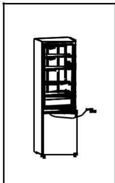
16) Montare la cerniera superiore sul lato sinistro del vano con un cacciavite
