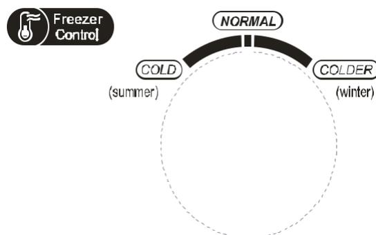
La temperatura del congelatore è piuttosto bassa in posizione "COLDER", mentre risulta piuttosto alta in posizione "COLD", pertanto generalmente viene utilizzata la posizione "NORMAL".
