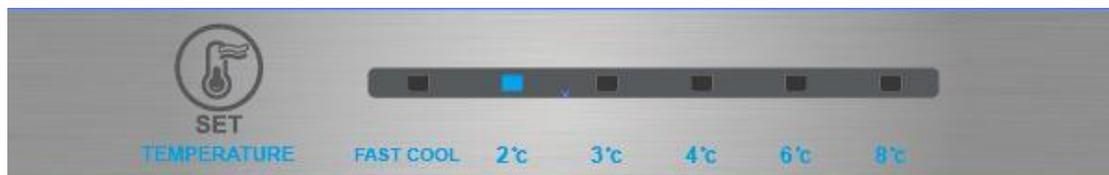
La temperatura di 2 °C è piuttosto bassa, quella di 8 °C è piuttosto elevata. La temperatura impostata generalmente è pari a 4 °C, secondo i requisiti.
