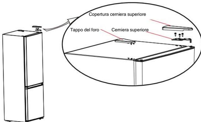
3) Rimuovere la porta del vano refrigerazione, la cerniera centrale e il tappo del foro.
