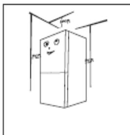
Sulla parte superiore del congelatore deve esserci uno spazio libero di almeno 30cm e le distanze da entrambi i lati e il lato posteriore devono essere superiori a 10cm per facilitare la dissipazione del calore.
