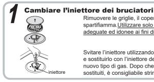
Rimuovere le griglie, il coperchio del bruciatore e lo spartifiamma. Utilizzare solo chiavi, attrezzature adequate ed idonee ai fini di non danneggiare l'injettore.
